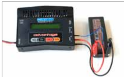
Anschluss eines LiPo-Akkus für Autos (mit SLPB Balancer Kabel)
