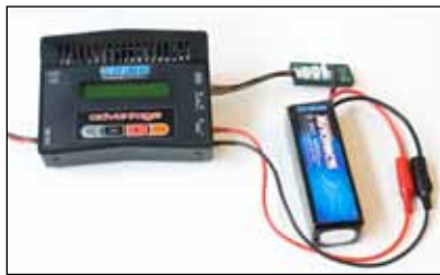
Collegamento batteria LiPo con adattatore bilanciamento
