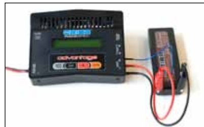
カー用バッテリーの接続 (SLPBバランシングコードを使用)
