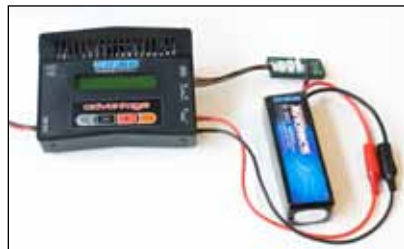
バランシングボードを使用した接続
