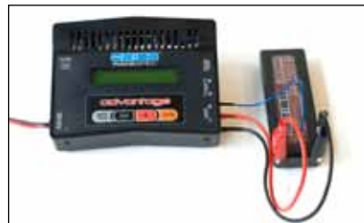
カー用バッテリーの接続 (SLPBバランシングコードを使用)
