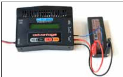
Connexion d'une batterie LiPo pour voiture (avec câble d'équilibrage SLPB)
