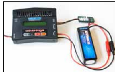
バランシングボードを使用した接続
