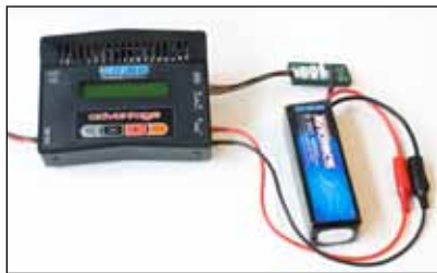
Connexion d'une batterie LiPo avec adaptateur d'équilibrage
